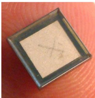
Miniaturisierung und Digitalisierung sind wichtige Treiber in der Medizintechnik. Hier eine von Fraunhofer IZM entwickelte Infusions-Mikropumpe.
