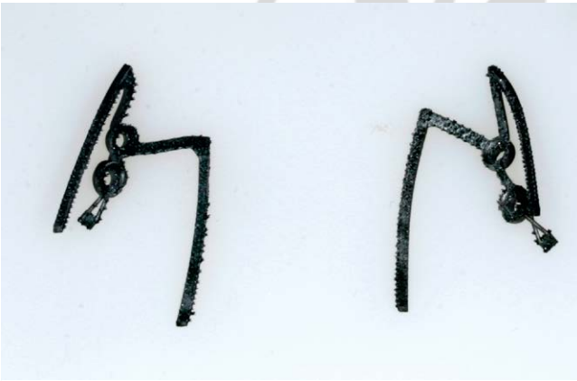
► Abb. 10 Beispielhafte Darstellung eines gedruckten Sliders nach dem Sinterprozess. Die Stützstrukturen sind bereits entfernt und das Gerüst gestrahlt.
